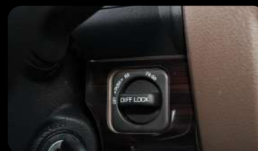
Interruptor de bloqueo del diferencial
