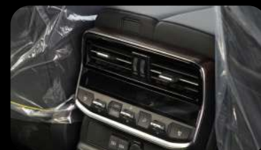
Salida trasera de aire acondicionado con control
