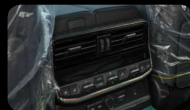
Salida trasera de aire acondicionado con control
